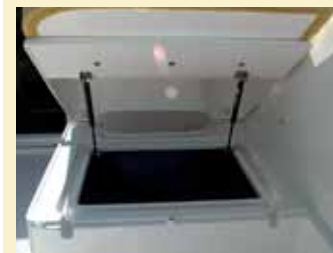
El volumen interior existente en el módulo que sirve de base al banco de pilotaje y al segundo asiento de la bañera se ha aprovechado para incluir otro generoso cofre de almacenamiento.
